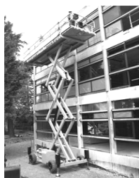
esempio di piattaforma con meccanismo di sollevamento a pantografo (fonte HAULOTTE ITALIA)
